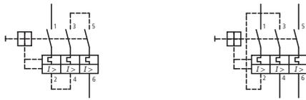
Защита ПВХ кабелей от термической перегрузки при коротком замыкании
